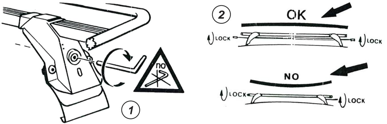
■ Serrer les vis de fermeture (1) jusqu'à ce que la barre porteuse soit horizontale (2).
