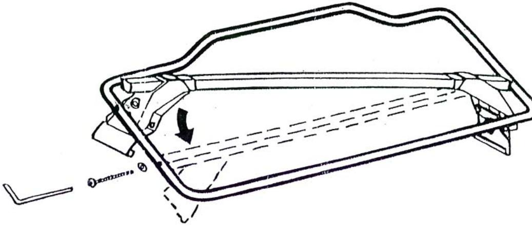
■ Fixer les barres au châssis à l'aide des vis longues.
