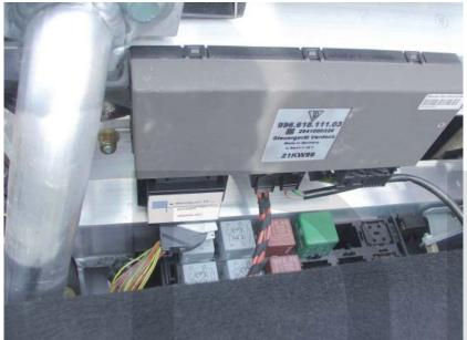
10. Branchez le module smartTOP à l'extrémité de l'unité de contrôle de toit.
