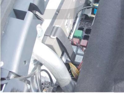
Serrez soigneusement et fixer ensemble, en s'assurant que le module de smartTOP ne glisse pas hors de la prise.
