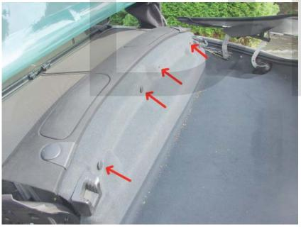
5. Enlevez les bouchons en plastique à l'aide d'un couteau ou d'un tournevis. Décrochez le tapis sous les «supports» en plastique en tirant doucement au milieu et sur les côtés.
