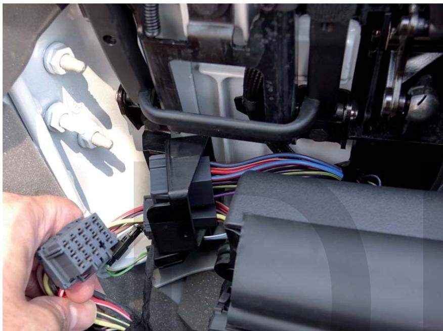
3. Débranchez le grand connecteur en poussant sur la languette de verrouillage sur le côté.
