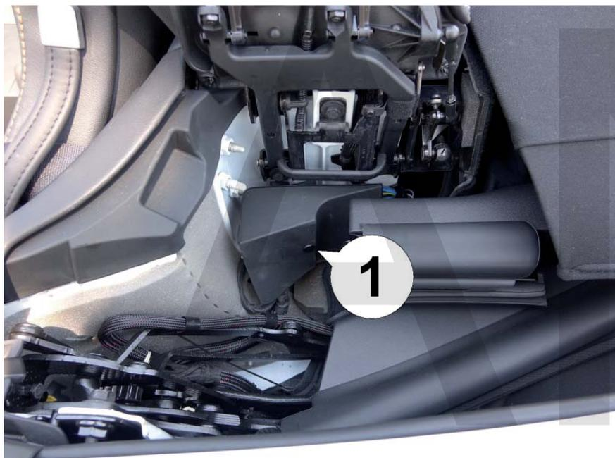
2. Sur votre côté gauche sous le rabat il y a un couvercle en plastique avec au milieu un rivet plastique gigogne (1)
