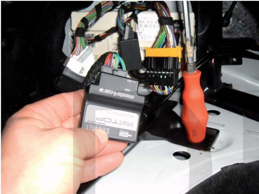
6. Connectez le module lui-même et appuyez une fois sur le bouton de déverrouillage de la télécommande.
