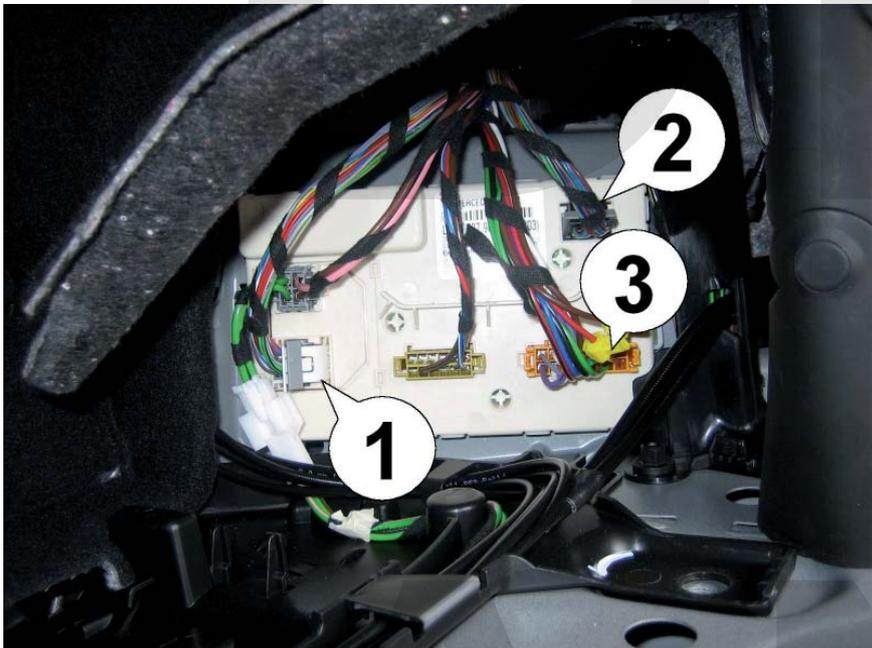
4. Retirez les trois connecteurs (1) (2) et (3) en appuyant sur les languettes de verrouillage.
