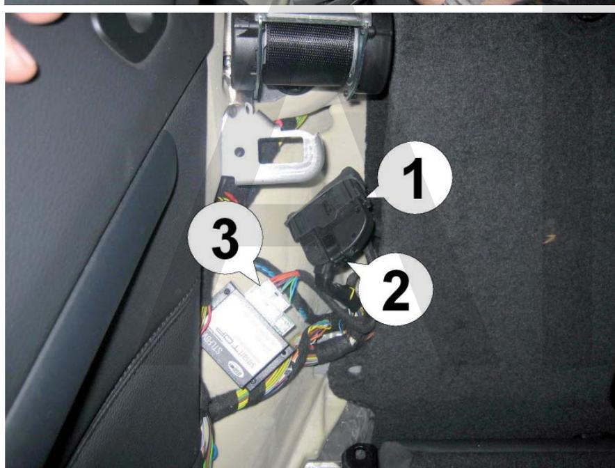
8. Branchez la prise d'origine à la prise sur le faisceau de câblage (1) et s'assurer que le levier (2) se mette correctement en place.
