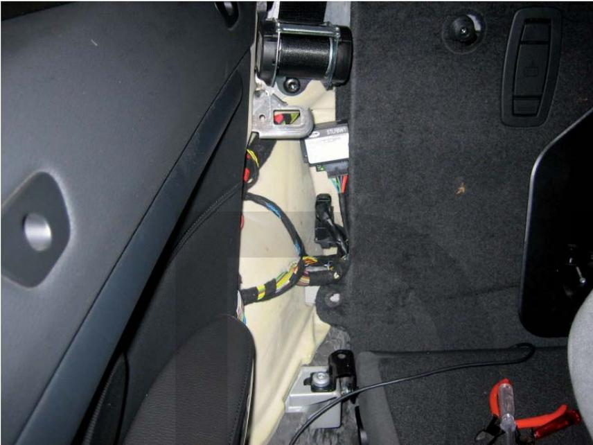
9. Rangez le module et les connecteurs dans le coin et remettre tout en place.
