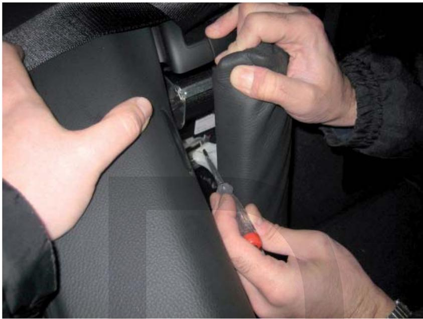
3. Soulevez le dossier, pour accéder au mécanisme de verrouillage blanc. Avec un tournevis dégager le.
