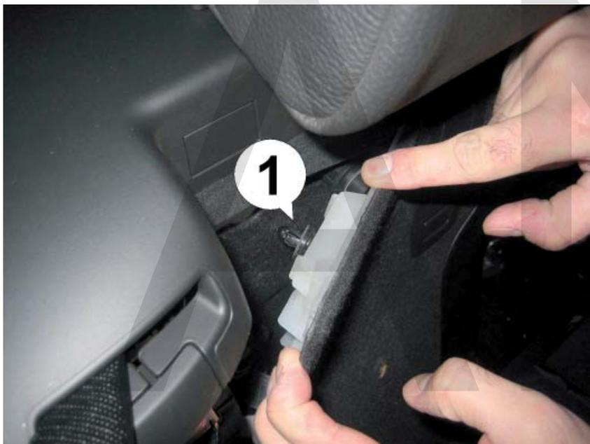
5. Sur le côté gauche arrière sous la moquette se trouvent des boulons en plastique. Dégager le boulon (1) en dessous de la partie supérieure de l'armature en métal.
