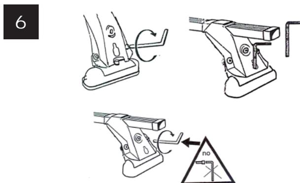
■ Serrer les vis en utilisant la clé Allen fournie.
