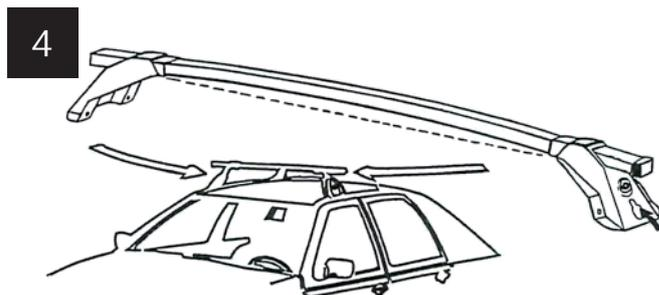
■ Positionner la barre et les supports sur les attaches.
