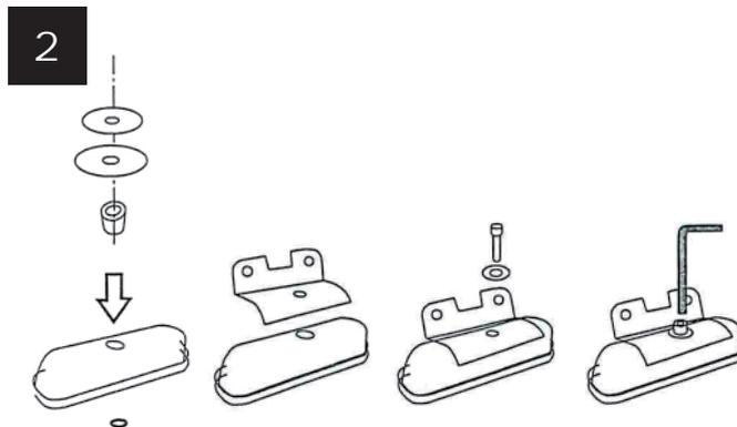
■ Visser les vis sans forcer en utilisant la clé Allen fournie.
